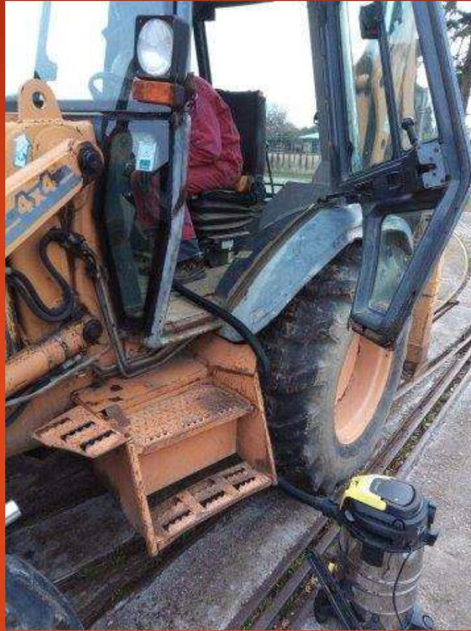
Nettoyage du tracto-pelle. Celui-ci est tombé en panne à deux reprises. Le dépanneur est venu sur place et a réparé la fuite d'huile due à un flexible de la direction usé par frottement sur un montant derrière le volant. Lors de la remise en route, deux belles fuites ont été constatées sur les vérins de la pelle arrière. Un devis a été demandé.
